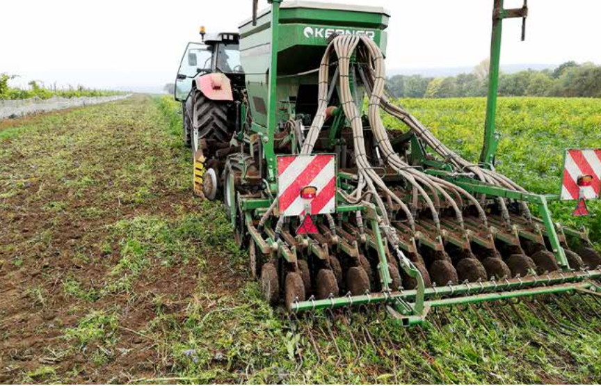
Aussaat von Weizen mit leichter Einarbeitung der Zwischenfrucht in den Boden.
