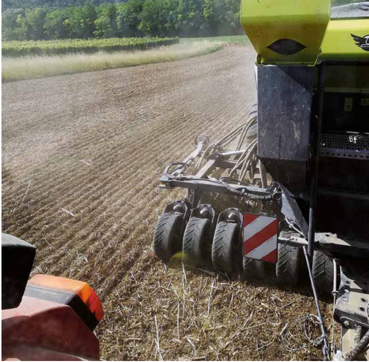
Sämaschine im No-Till-Verfahren bei der Aussaat einer Zwischenfrucht
