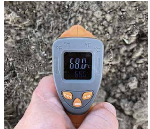
Temperaturmessung im „nackten Feldboden“ im Sommer bei Sonnenschein
